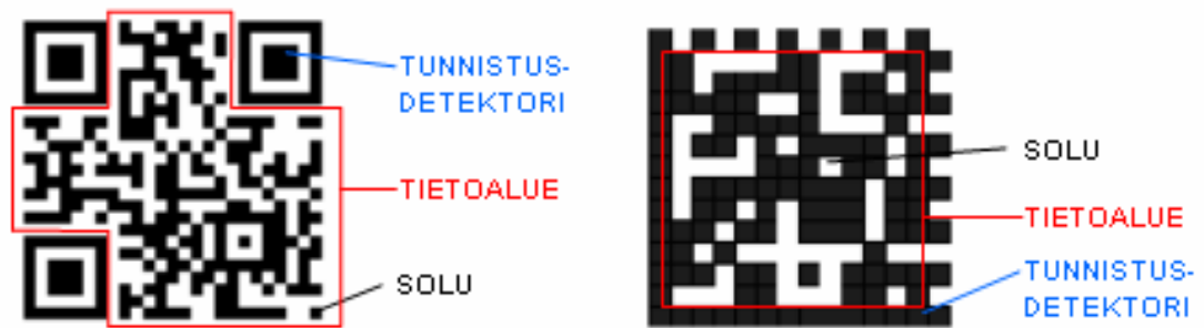
Kuva 13. QR-koodin (vasemmalla) ja datamatriisikoodin (oikealla) rakenne
