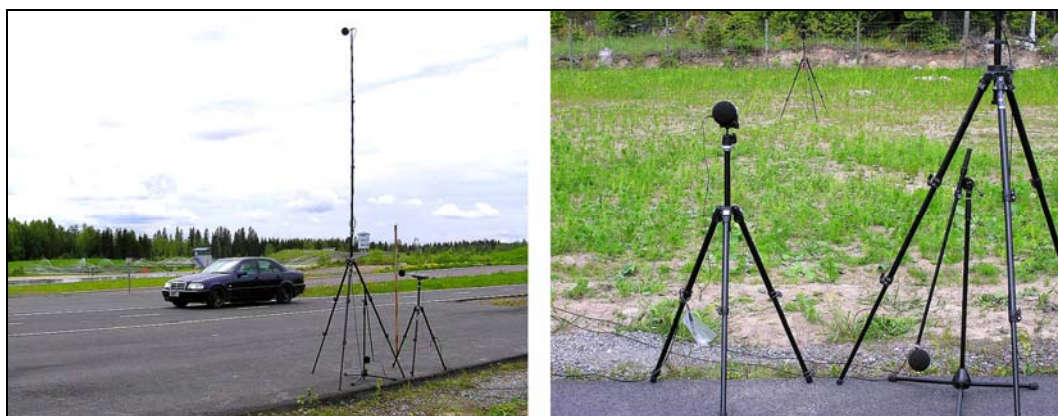
Kuva 30. Mikrofonit Nokian Renkaiden koeradalla. Oikean puoleisessa kuvassa näkyy taustalla kaukopisteen mikrofoni.
