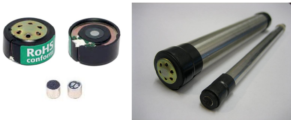
Kuva 51. Vasemmalla mikrofonikapselit; dynaaminen (ylhäällä) ja elektreetti (alla). Oikealla rakennetut mikrofonit; dynaaminen (ylhäällä) ja elektreetti (alla).
