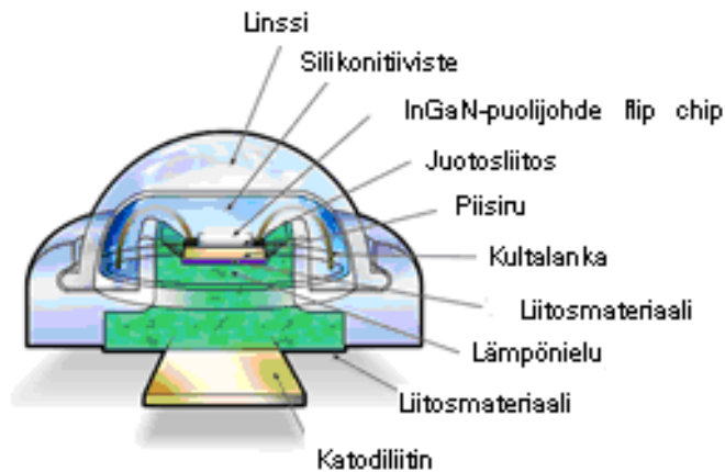
Kuva 12. LED-komponentin rakenne (Dow Corning 2009).
