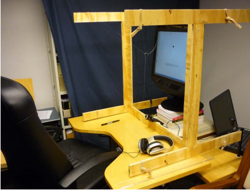
Kuva 10. Laboratorion tutkimushuone nro. 1 Tobii-katseenseurantalaitteistolla, joka on integroitu monitoriin. Kuvassa ovat nähtävissä myös videokamera kehikossa, kuulokkeet, Skype-yhteyttä pyörittävä tietokone (oikealla) sekä mikrofonina toimiva web-kamera monitorin edessä alhaalla.
