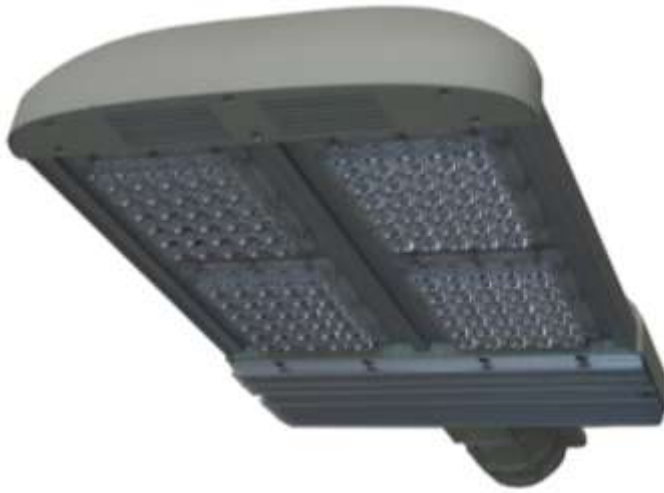
Kuva 14: LedZed International Ltd Oy:n valmistama LedZed 120x1W. Mitattu valaisinteho P = 139,1 W, valovirta \Phi = 7879 lm, valon värielämpötila CCT = 6661 K ja värintoistoindeksi CRI (R_a) = 83 .
