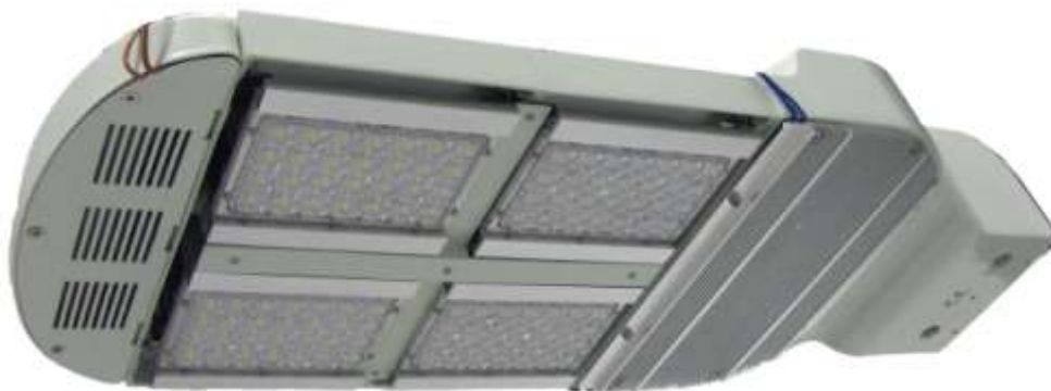
Kuva 13: HR Light Oy:n maahantuoma HR 150. Mitattu valaisinteho P = 133,3 W, valovirta \Phi = 5280 lm, valon värielämpötila CCT = 3220 K ja värintoistoindeksi CRI (R_a) = 71 .
