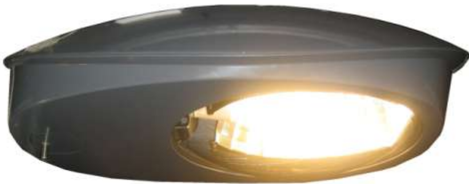
Kuva 19: Sitecon valmistama SQ100 QL85W induktiolampulla. Mitattu valaisinteho P = 78,3 W, valovirta \Phi = 4382 lm, valon värielämpötila CCT = 3122 K ja värintoistoindeksi CRI (R_a) = 78 .
