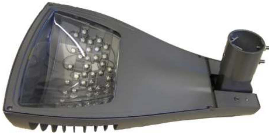
Kuva 15: iGuzzinin valmistama Archilede 84*1W. Mitattu valaisinteho P = 109,9 W, valovirta \Phi = 6320 lm, valon värielämpötila CCT = 6155 K ja värintoistoindeksi CRI (R_a) = 71 .
