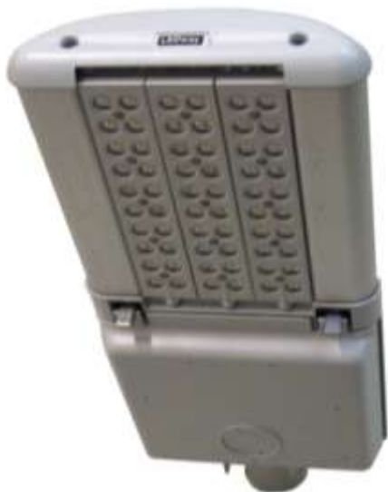
Kuva 12: Ruud Lightingin valmistama Ledway Road 60. Mitattu valaisinteho P = 107,5 W, valovirta \Phi = 6319 lm, valon värielämpötila CCT = 3469 K ja värintoistoindeksi CRI (R_a) = 84 .
