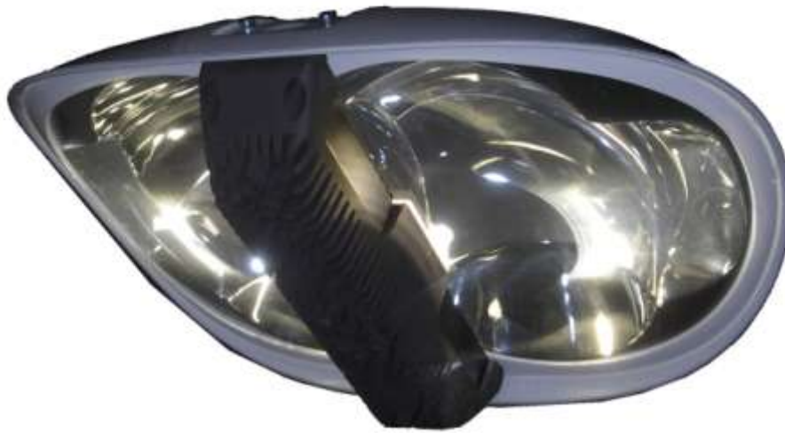
Kuva 16: Lumi Group Oy:n valmistama Lumi R. Mitattu valaisinteho P = 94,6 W, valovirta \Phi = 5598 lm, valon värielämpötila CCT = 4662 K ja värintoistoindeksi CRI (R_a) = 80 .
