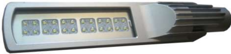
Kuva 18: DirectNu Energy yrityksen toimittama pienjännitevalaisin. Mitattu valaisinteho P = 21,8 W, valovirta \Phi = 1660 lm, valon värielämpötila CCT = 49121 K ja värintoistoindeksi CRI (R_a) = 69 .
