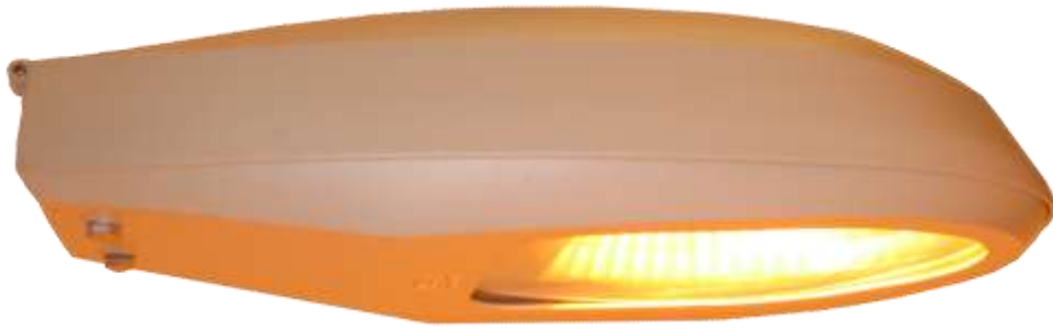
Kuva 22: Strihlin valmistama Mistral HPS100W suurpainenatriumlampulla. Mitattu valaisinteho P = 112,9 W, valovirta \Phi = 7110 lm, valon värielämpötila CCT = 1957 K ja värintoistoindeksi CRI (R_a) = 30 .
