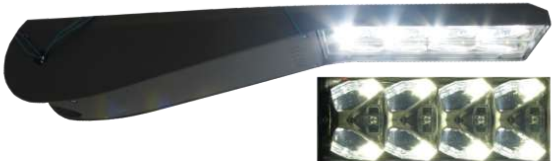
Kuva 17: Sitecon valmistama SL10 mini sekä suurennus ledi- ja heijastinosiosta. Mitattu valaisinteho P = 49,9 W, valovirta \Phi = 3457 lm, valon värielämpötila CCT = 4637 K ja värintoistoindeksi CRI (R_a) = 68 .
