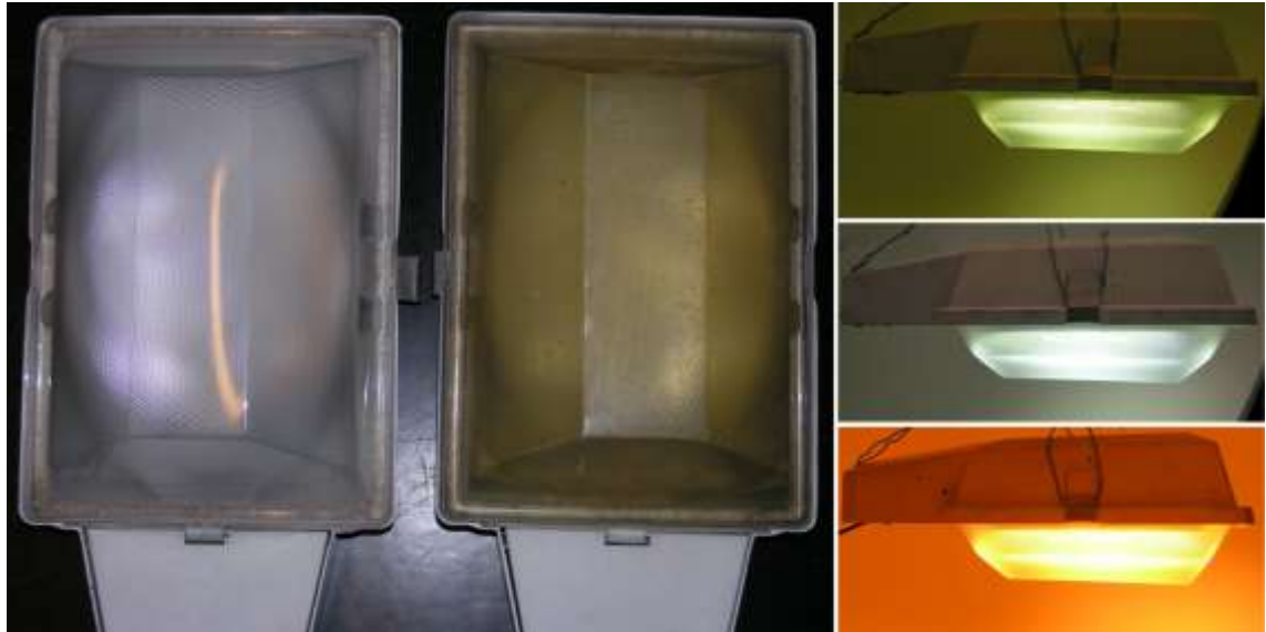
Kuva 24: Siemens 5062542 tievalaisin. Vasemmalla on vierekkäin vertailtavat valaisimet varustettuina uusitulla ja alkuperäisellä kellastuneella suojakuvulla. Oikealla päällekkäin ylhäältä lukien 125W HG vanhalla kuvulla, 125W HG uudella kuvulla ja 70W HPS uudella kuvulla.
