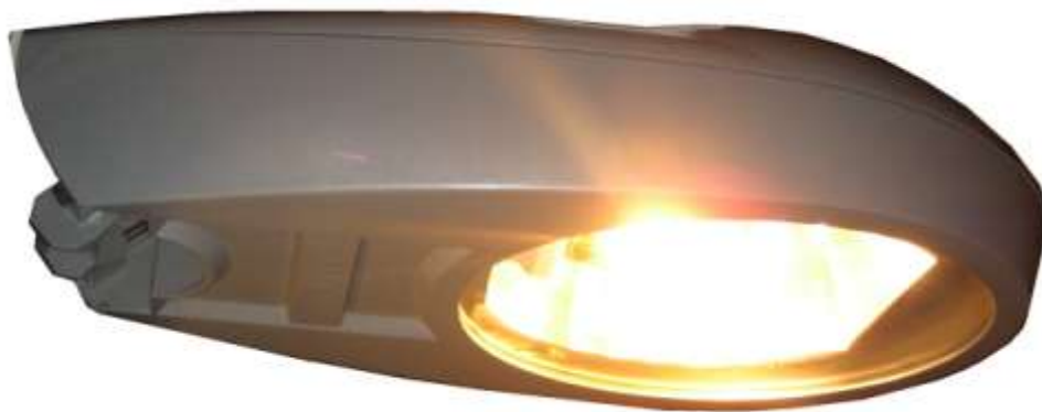
Kuva 21: Sitecon valmistama SC100 HPS70W suurpainenatriumlampulla. Mitattu valaisinteho P = 88,1 W, valovirta \Phi = 5021 lm, valon värielämpötila CCT = 1907 K ja värintoistoindeksi CRI (R_a) = 24 .
