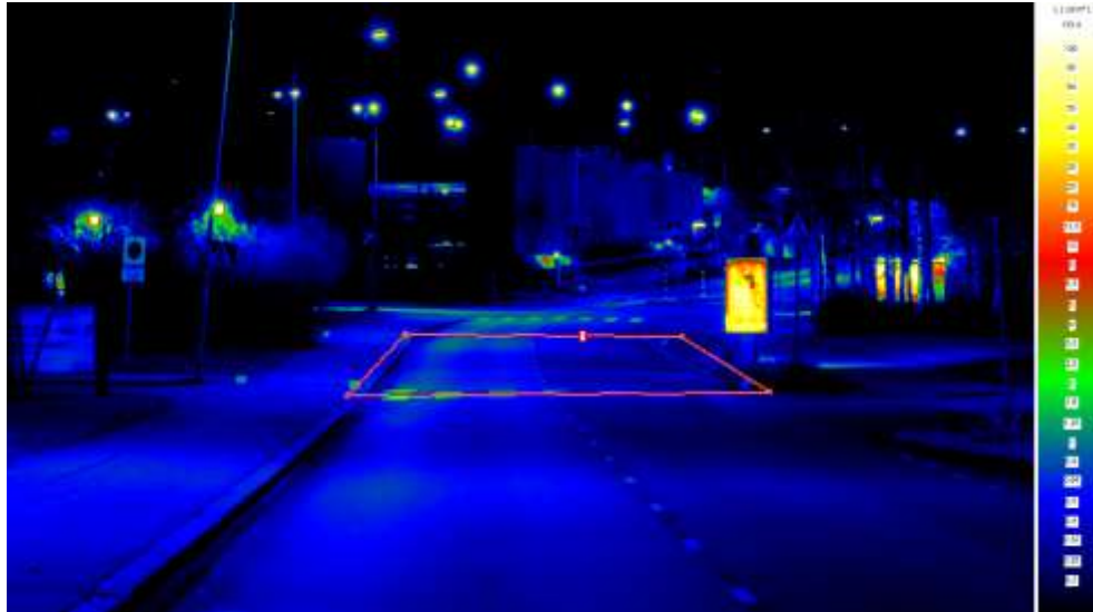
Kuva 36: Väärävärivaku tieosuuden vasemmalta kaistalta otetusta mittauksesta.
