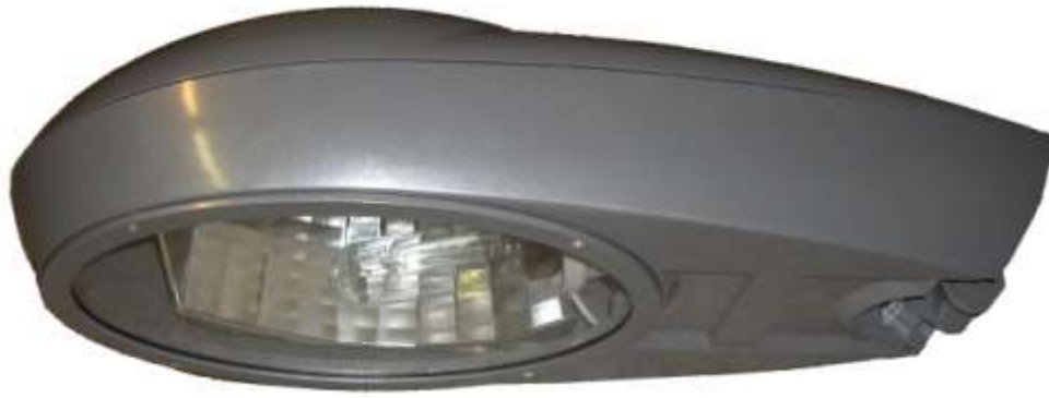
Kuva 20: Sitecon valmistama SC100 HPS100W suurpainenatriumlampulla. Mitattu valaisinteho P = 114,4 W, valovirta \Phi = 6878 lm, valon värielämpötila CCT = 1951 K ja värintoistoindeksi CRI (R_a) = 27 .
