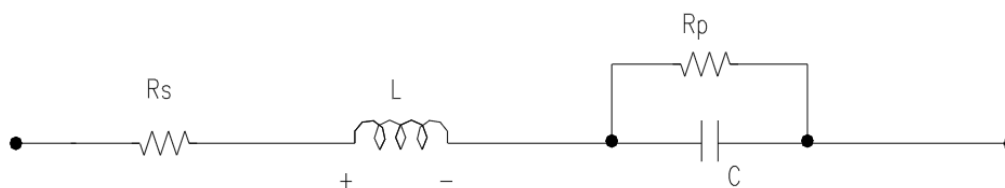
Kuva 3.4 Superkondensaattorin ensimmäisen asteen sijaiskytkentä (NessCap 2008).
