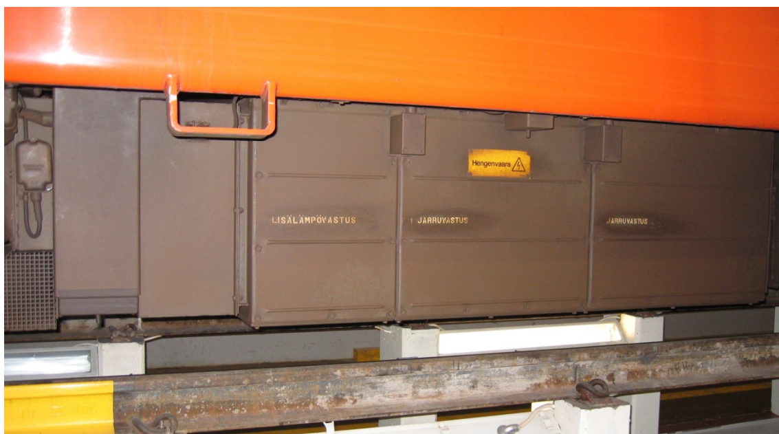
Kuva 4.1 Junan telikäyttöyksikössä D5 sijaitsevat jarruvastukset ja lisälämpövastus.
