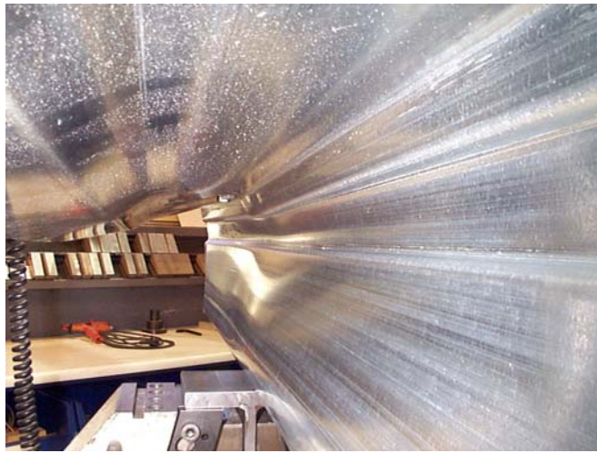
Fig. 3.25 Web crippling in test ITF200R-t15-1.
