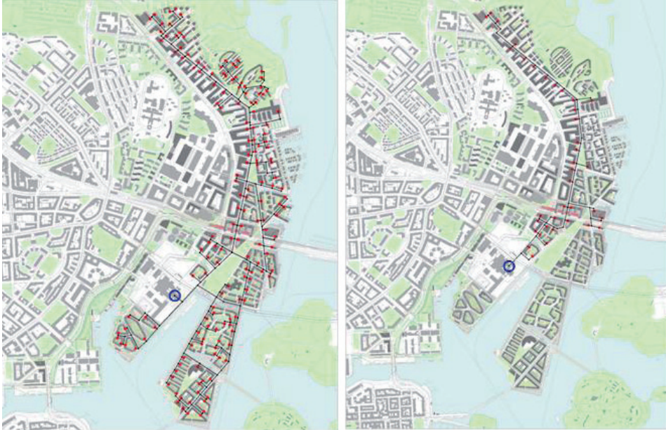
Kuva 6. Kalasataman kaukolämmitys- (vas.) ja kaukojäähdytysverkot kulutuspiisteineen.
