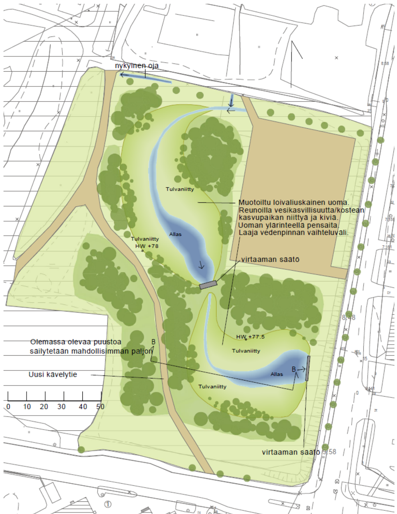
Kuva 28 Hulevesien viivytysaltaat Launeenkadun ja Tapparakadun risteysalueen läheisyydessä Lahdessa. Altaisiin johdettavat hulevedet virtaavat nykyisin viemäreissä jotka ovat rankkasadetilanteessa herkästi tulvia. Johtamalla hulevedet viemäristä suunniteltuihin altaisiin saadaan hulevesivirtaamia viivytettyä ja havaittu tulvimisriski eliminoitua. (Kuva: Pyöry Finland Oy)
