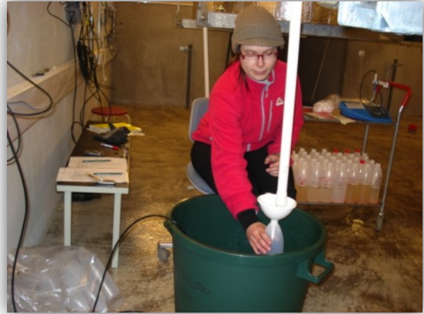
Kuva 14 Vesinäytteet otettiin viemärikerroksen salaojaputkesta ja samalla mitattiin veden johtokyky. (Kuva Marjo Valtanen)
