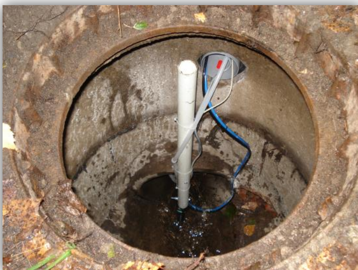
Kuva 3 Veden laatua ja virtaamaa mitattiin anturein viemäriputkessa. Etualalla putken suulla ovat johtokyky- ja sameusanturit ja sisempänä putkessa sijaitsi virtaama-anturi sekä näytteenottoletku. (Kuva Marjo Valtanen)
