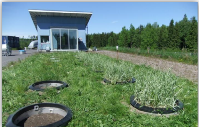
Kuva 12 Lysimetreihin asetetut biosuodatusrakenteen kasvilliset rakenteet maanpinnalta katsottuna (Kuva: Marjo Valtanen)
