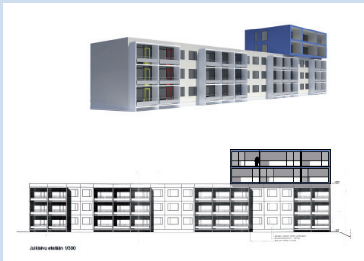
Kuva 30. Siltamäen lamellitalon yhden lamellin korotus.
