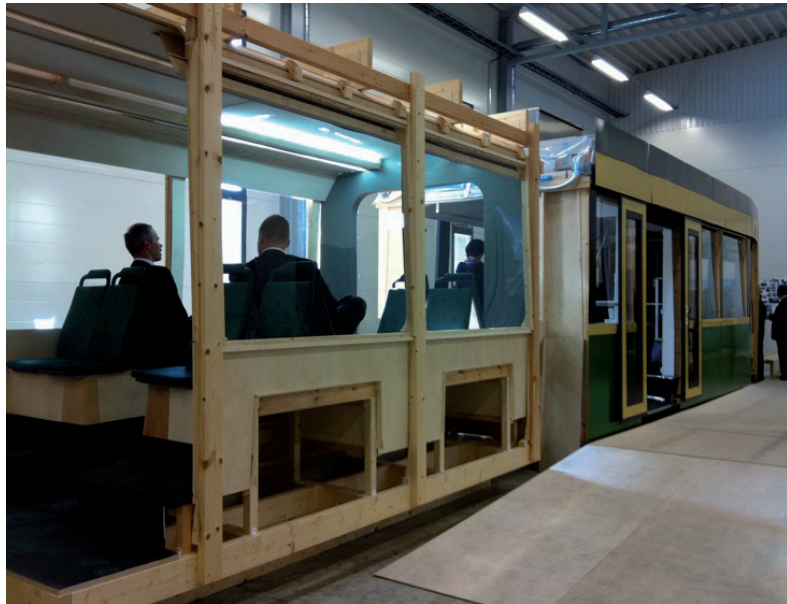
Kuva 14. Uuden raitiovaunun suunnittelua prototyypin avulla (kuva Karhu)
